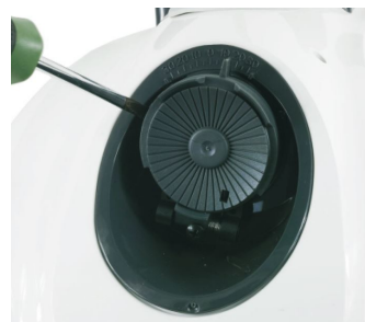
8.2: Gebruik een platte schroevendraaier om de klep schroevendraaier om de klep montage uitelkaar te halen zoals getoond
